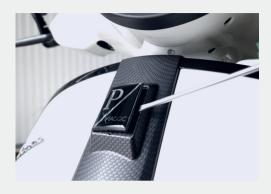
Kaskadenemblem mit Schraubendreher S5 von links anheben und aus der Kaskade entfernen.
