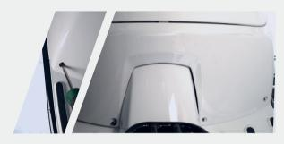
Die vier Schrauben des Gepäckfaches mit TX25 lösen und entfernen.
