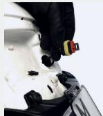
Die Mutter für den Rücklichthalter mit SW10 lösen und entfernen. Das Rücklicht abnehmen und die Steckverbindung aus dem Halter ziehen. Die Steckverbindung trennen.
