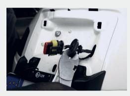
Die Gummi-Kabeldurchführung aus dem Heckteil ziehen und von der Seite bis zur Öffnung in der Mitte des Gummis mit einem Seitenschneider einschneiden. Das Gummi abnehmen.
