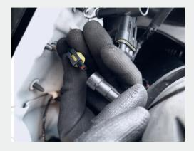
Jeweilige Steckverbindung der Blinker zusammenstecken und dabei auf das Einrasten der Sicherung am Steckergehäuse achten. Die Stecker für die Positionsleuchten vom Adapter mit den Steckern der Blinker verbinden und dabei auf das Einrasten der Sicherung am Steckergehäuse achten.
