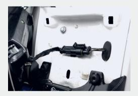
Die Steckverbindung zwischen Rücklicht und Adapter zusammenstecken und auf das Einrasten der Sicherung am Steckergehäuse achten. Die Steckverbindung wieder in den Halter am Heckteil einsetzen. Das Rücklicht auf das Heckteil setzen und die Mutter mit SW10 befestigen.
