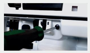
Gepäckfachklappe öffnen. Die zentral gelegene Schraube mit TX27 lösen und entfernen.
