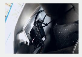
Kabel des Adapters für die Positionsleuchten und der Blinker mit Kabelbindern an den originalen Kabelhaltern befestigen und dabei darauf achten das die Kabel keinen Kontakt zu Fahrwerksteilen haben können.
