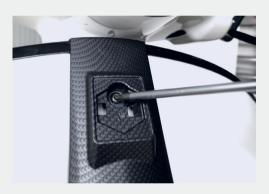
Die darunter liegende Schraube mit TX25 lösen und entfernen. Die Kaskade nach vorne abziehen.
