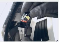
Das Gepäckfach nach hinten so weit abziehen, dass die Blinker zugänglich werden. Dabei auf die Engstelle unterhalb der Lenkerverkleidung achten, damit es hier nicht zu Beschädigungen kommt.
