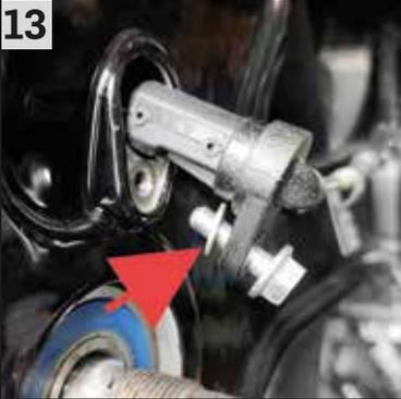
Um den Abstand zum Tonrad einzustellen, kann der ABS-Sensor mit Passscheiben unterlegt werden.
