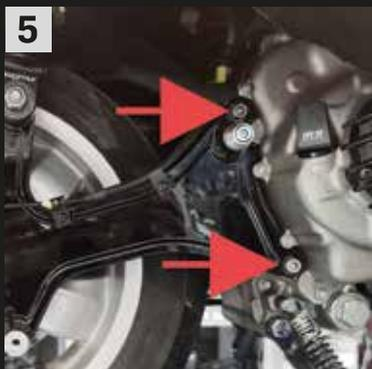
Zwei Schrauben der Schwinge am Motorgehäuse mit IS 6 lösen und entfernen. Dabei auf den Verbleib der Scheiben und Sicherungselemente achten. Schwinge von der Radwelle abziehen.
