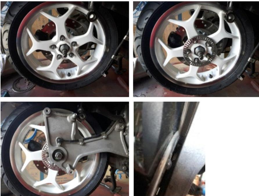
Nach erfolgreicher Montage benötigt das ABS, aufgrund des geänderten Radumfangs, eine Rekalibrierung
