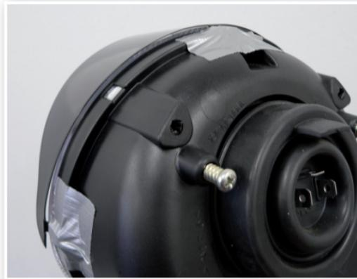
8. Das Schirmchen mit etwas Klebeband fixieren. Das Klebeband hält das Schirmchen an seinem Platz während der Scheinwerfer wieder verschraubt wird.
