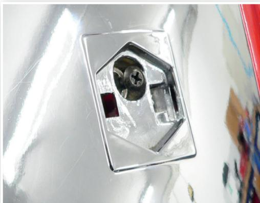
3. Die Kreuzschraube hinter dem Piaggio Emblem entfernen.
