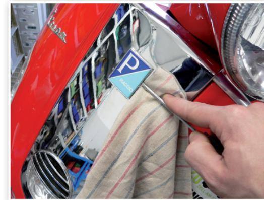
2. Die Kaskade demontieren. Dazu muss das geklebte Piaggio Schild auf der Kaskade mit einem flachen Schraubendreher sanft ausgehebelt werden. Den Schaft des Schraubendrehers abpolstern und beim Hebeln nicht drehen da sonst der Lack beschädigt werden kann.
