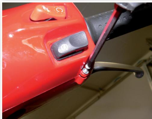
4. Beide Kreuzschrauben, die sich unterhalb der Lenkkopfabdeckung, jeweils am Ende des Lenkkopfs direkt unter den Bremshebeln befinden, entfernen.
