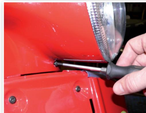
5. Die untere der beiden Schrauben unterhalb des Scheinwerfers lösen.
