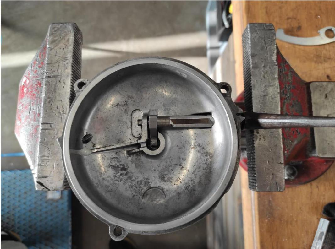
Neuen O-Ring (BGM12OR119N) in die Nut des Kupplungsdeckels mit etwas Fett einlegen und Kupplungsdeckel montieren (SW10, 5-6Nm)
