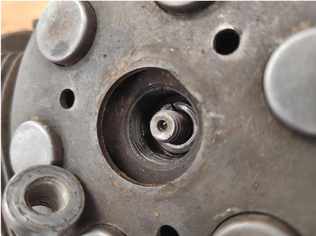
Kupplungsabzieher (1800023) in die Kupplungsnahe einschrauben (SW19) und Kupplungshaltewerkzeug umstecken um die Kupplung gegen verdrehen zu sichern.
