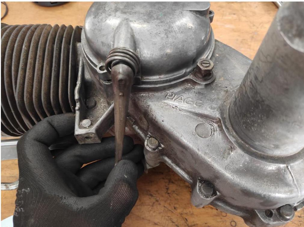
Andruckplatten Feder aushängen und Andruckplatte entnehmen.
