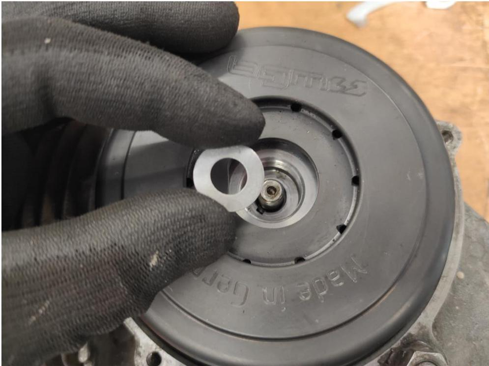
Kupplungsmutter (7674512) ansetzen, die Kupplung gegen verdrehen mit dem Kupplungshaltewerkzeug sichern und die Mutter 60-65Nm befestigen.
