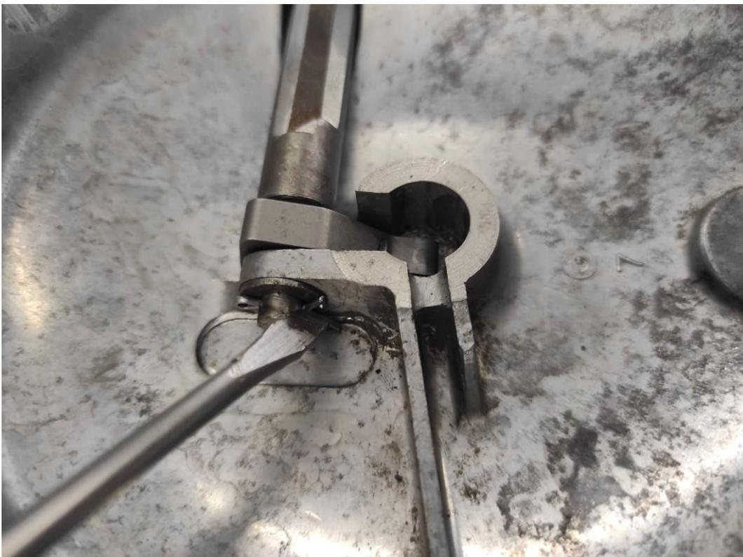
Ist der Splint (4940049) entfernt, kann der Kupplungsarm aus dem Kupplungsdeckel gezogen werden.
