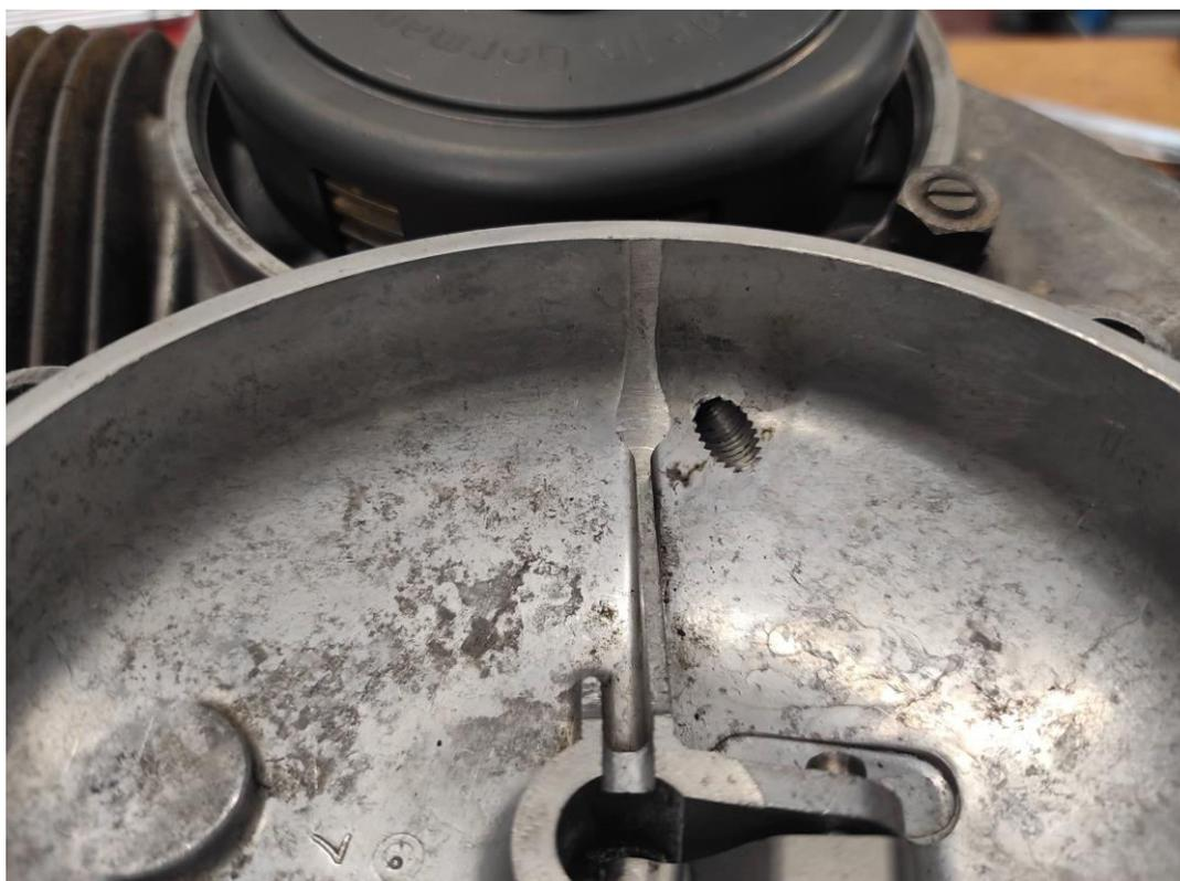
Den Kupplungsarm ggf. mit neuer Dichtung (3332349) und neuem Splint und der Kupplungsarmfeder einbauen und sichern.
