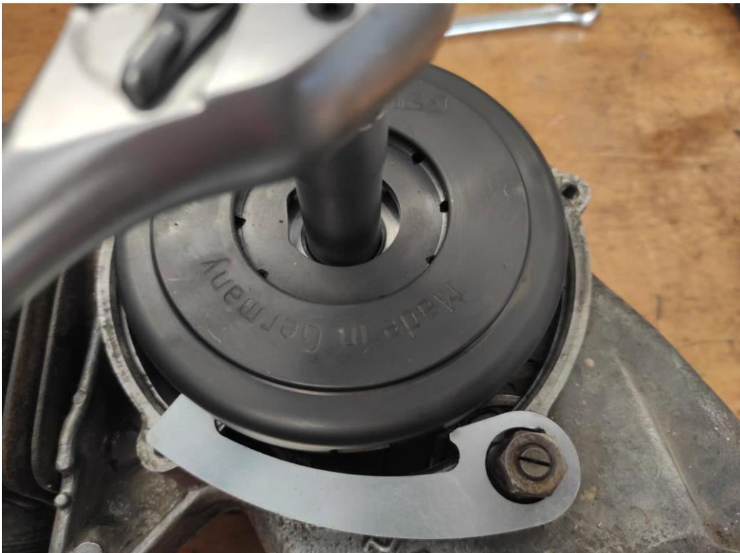
Bei der bgm Superstrong passen ausschließlich die Kupplungsandruckplatten mit seitlicher Abflachung. Es passen daher die Serienandruckplatten aller GS/SS Modelle mit Ausnahme der ganz frühen GS150 VS1 Modelle (bis Rahmennummer 6223). Für optimale Ergebnisse empfehlen wir die BGM PRO Kupplungsandruckplatte (BGM8007) zu verwenden. Diese einlegen und die Andruckplattenfeder im Kupplungskorb einhängen.
