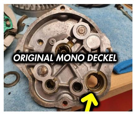
Da ein original Monogehäusedeckel ein Maß von 24,32mm hat (siehe Bild), muss dieses erstmal auf das Maß eines Variodeckels gebracht werden. Nämlich auf 17,30mm (siehe Bild)
