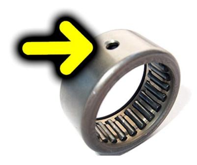
Es kann natürlich auch alternativ ein Nadelager ohne Bohrung verwendet werden. Als Nächstes wird das Nadellager so ausgerichtet, dass die Ölbohrung zur Nut zeigt und soweit reingepresst, dass dieses bündig abschließt (siehe Bild) .
