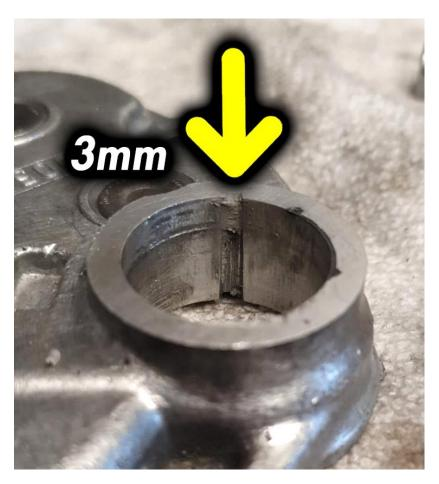
Nachdem das erledigt ist und der Kleber vollständig ausgehärtet ist, wird das Lager eingesetzt. Als Nadellager wird im Optimalfall ein "**HK1712AS1B**" mit Ölbohrung verwendet (siehe Bild).
