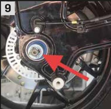
Schwinge auf die Radwelle stecken. Distanzring auf die Radwelle stecken und die zentrale Mutter mit SW24 mit 110 – 126Nm anziehen. Anschließend die Sicherungskappe aufstecken und diese mit einem Splint 3,5x32 sichern.
