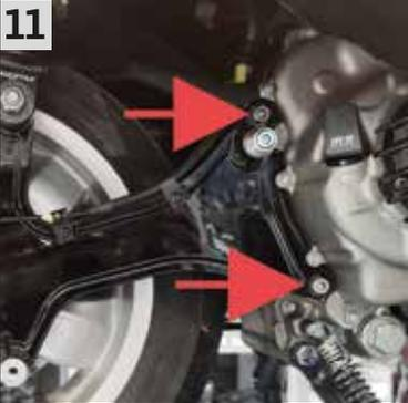
Zwei Schrauben der Schwinge am Motorgehäuse einsetzen und mit IS6 mit 20 – 25Nm anziehen.
