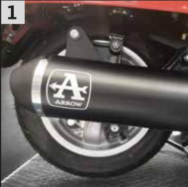
Auspuffschelle am Krümmer mit SW17 lösen. Drei Schrauben am Auspuff mit TX40 lösen und entfernen. Anschließend den Auspuff abnehmen.
