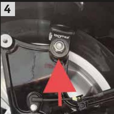
Untere Mutter des Stoßdämpfers mit SW17 lösen. Mutter und Unterlegscheibe entfernen und anschließend den Stoßdämpfer von der Aufnahme abziehen.
