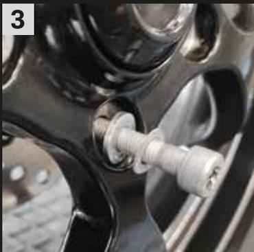
Vorderrad abnehmen. Rad mit der bgm Pro 13 Zoll Felge auf die Nabe setzen und die Bohrungen für die Radschrauben zur Nabe deckungsgleich ausrichten. Zur Montage der bgm Pro Felge am Vorderrad ausschließlich Radschrauben in der Größe M8x35mm mit einer Zugfestigkeit von 8.8 verwenden. Beim Einsetzen der Radschrauben auf die korrekte Reihenfolge der Scheiben und Sicherungen achten. Anschließend die Radschrauben über Kreuz mit 20 – 25 Nm anziehen
