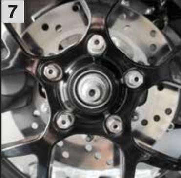
Rad mit der *bgm* Pro 13 Zoll Felge auf die Nabe setzen und die Bohrungen für die Radschrauben zur Nabe deckungsgleich ausrichten. Beim Einsetzen der SW12 Sechskant-Radschrauben auf die korrekte Reihenfolge der Scheiben und Sicherungen achten. Anschließend die Radschrauben über Kreuz mit 20 – 25 Nm anziehen.
