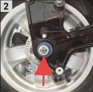
Sicherungssplint und Sicherungskappe der Zentralmutter entfernen. Die zentrale Radmutter mit SW24 lösen und entfernen. Distanzring von der Radwelle abziehen.
