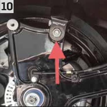
Stoßdämpfer auf die Halterung stecken und mit Scheibe und Selbstsichernder Mutter SW 17 mit 40 – 45Nm anziehen.
