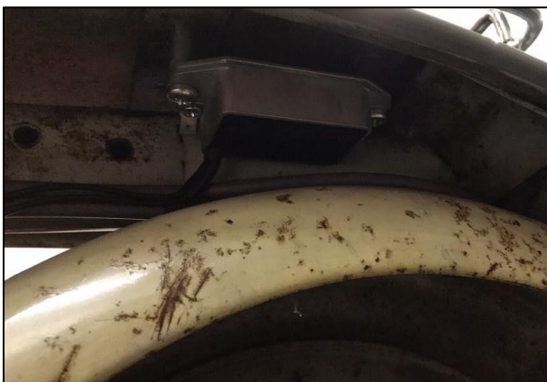
Abbildung 7 - Der Spannungsregler passt mit Langmuttern auf die Gepäckträgerschrauben
