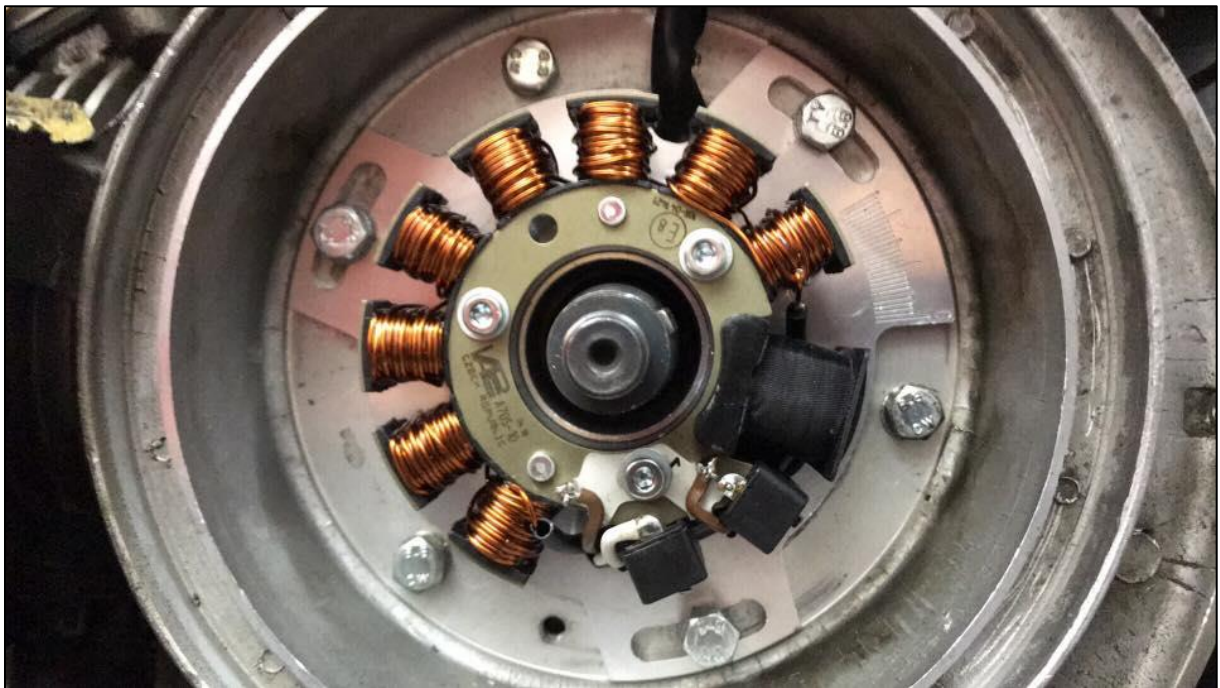
Abbildung 1 – Grundplatte mit Stator
