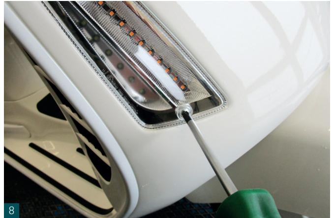
8 Einen Blinker vorne lösen. Unscrew a front indicator.
