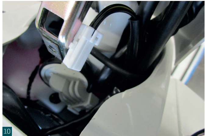
10 Anschluss für das Tagfahrlicht zum Lenker verlegen. Move daytime running light plug to handlebar.
