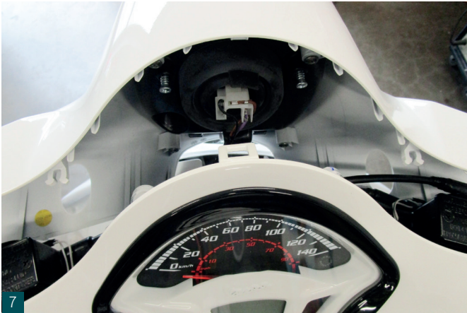
7 Lenkerverkleidung nach vorne abziehen. Scheinwerferstecker abziehen. Pull handlebar cover forward. Remove headlight plug.
