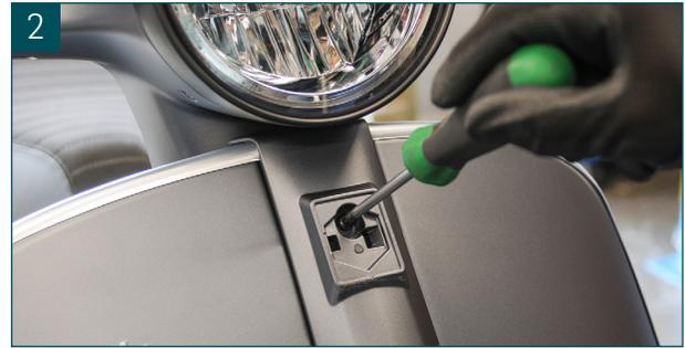
Als Nächstes entfernen wir die beiden Abdeckungen rechts und links vom Lenker am inneren Beinschild.
