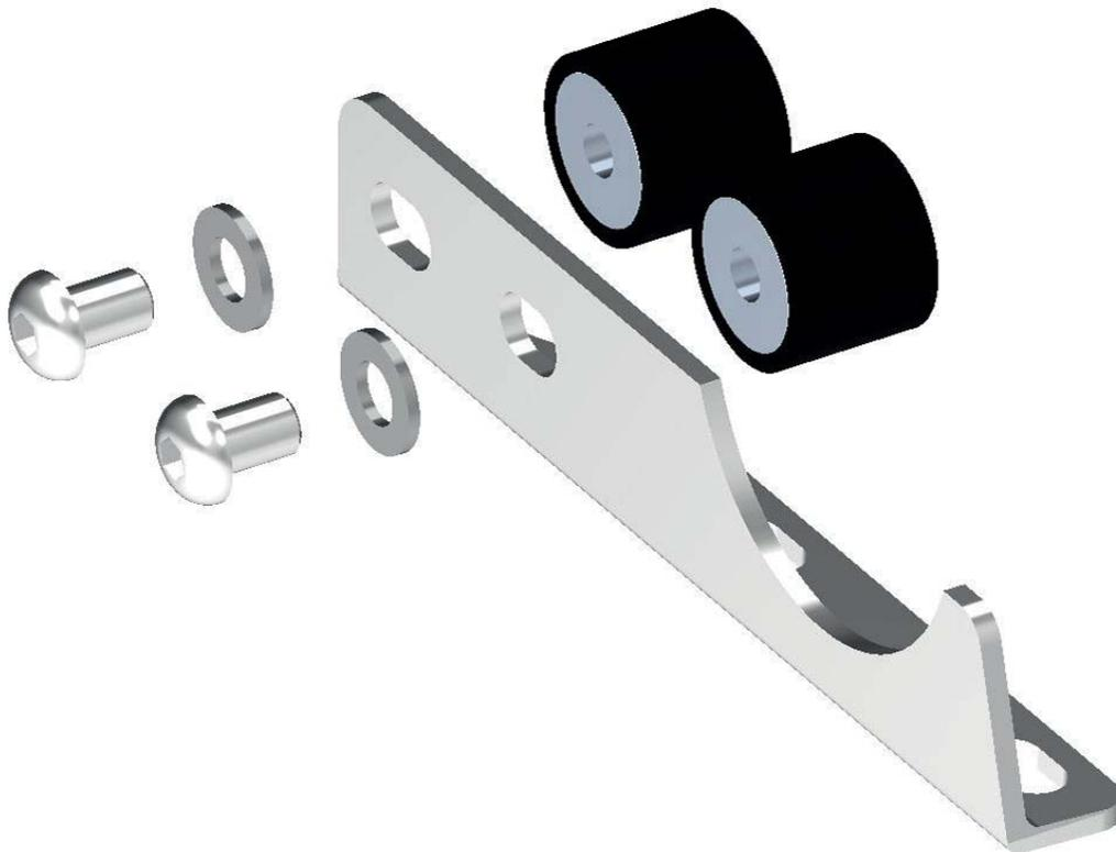
2. Ancorare ora la staffa con l'anello di collegamento e posizionare sul braccio del carter motore senza però stringere le viti
