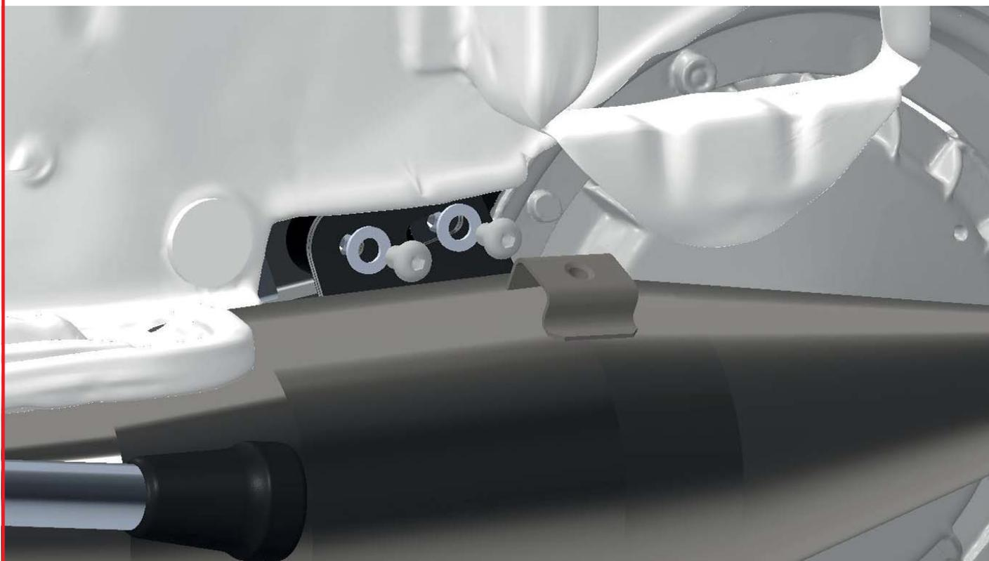
4. Si può procedere quindi al fissaggio dell'impianto di scarico, la prima operazione da effettuare consiste nel fissare la staffa di sostegno precedentemente inserita nel braccio del carter con la marmitta utilizzando le rimanenti viti M6x16 con relative rondelle:
