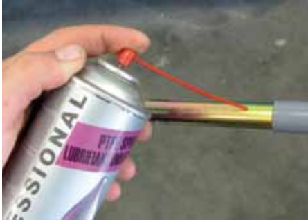
3. Innenrohre mit Trockenschmierstoff (PTFE-Spray) einsetzen.
