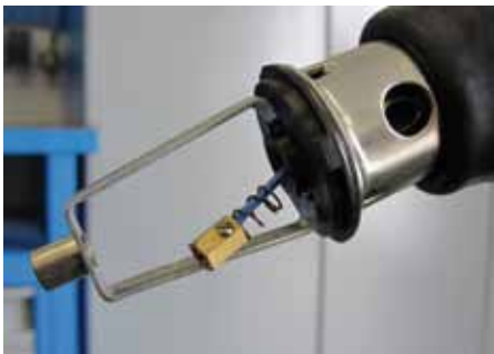
7. Blinkerkabel und Zuleitung Blinkerschalter einziehen. Rosa = rechts; Blau = links; Orange vom Kabelbaum (9077011) = Zuleitung Blinkerschalter.
