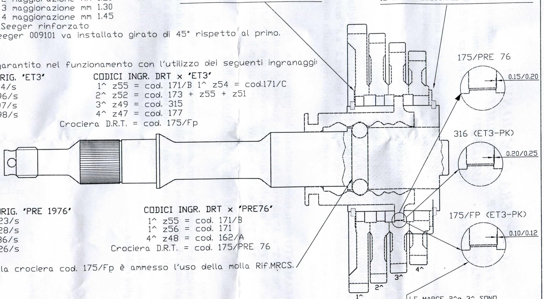
LE MARCE 2^e 3^ SONO ALLINEATE ALLA CROCIERA QUANDO IL DENTE DI PRESA SPORGE DA AMBO I LATI IN MISURA IDENTICA, DI CONSEGUENZA 1^e 4^ SONO ALLINEATE.
