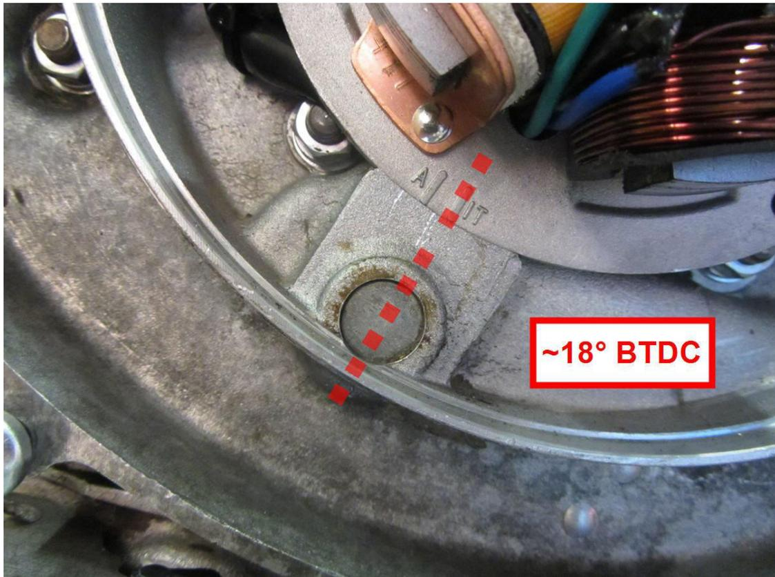
Soll ein Zündzeitpunkt von weniger als 18° eingestellt werden, ist es notwendig eines der Befestigungslöcher in der Grundplatte zu erweitern (Langloch):
